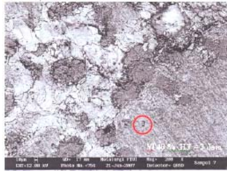
Gambar 7. SEM Al/Al 2 O 3 Vf 40% Waktu Tahan 2 Jam
